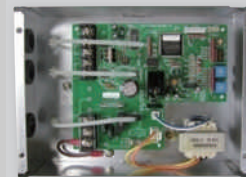
BMS-IFWH5E Relais pour comptage d'énergie
